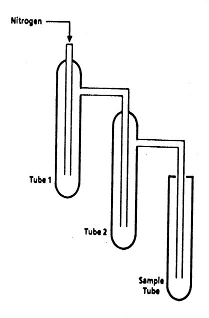
FIGURE 1. GASEOUS DIAZOMETHANE GENERATOR
